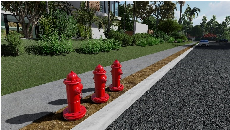
Gambar 15. Ilustrasi penempatan pipa hydrant jalan
